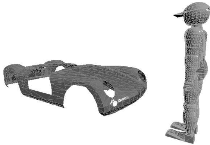
Abbildung 4.12: Szenario zum Test der Kollisionserkennung; die Karosserie setzt sich aus 1218 und die Figur aus 5640 Dreiecken zusammen
